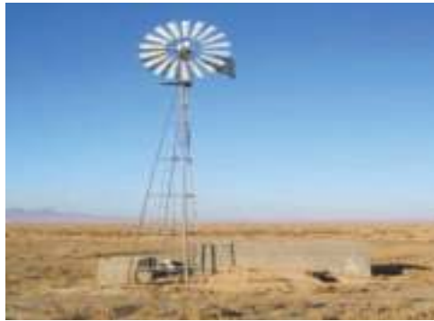
شکل ۱. استفاده از انرژی باد برای بالا کشیدن آب از چاه
